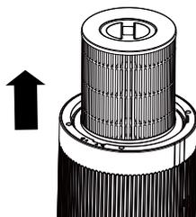
3. La surface extérieure du filtre doit être nettoyée toutes les 2 à 4 semaines pour augmenter l'efficacité et prolonger la durée de vie du filtre. Nettoyez la surface extérieure du filtre à l'aide d'un chiffon doux pour enlever les cheveux, la poussière et les grosses particules.
