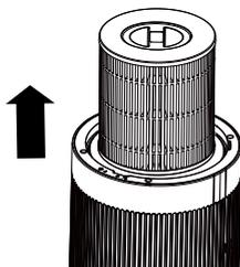
3. La superficie exterior del filtro debe limpiarse cada 2-4 semanas para aumentar la eficiencia y extender la vida útil del filtro. Limpie la superficie exterior del filtro con un paño suave para eliminar el cabello, el polvo y las partículas grandes.
