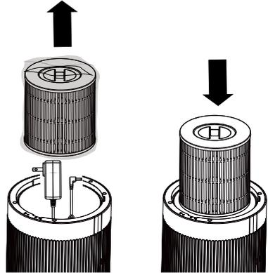
3. Reemplace la tapa del filtro. Asegúrese de que el triángulo de la tapa del filtro esté alineado con el triángulo del borde inferior del purificador de aire. Después gire en el sentido de las agujas del reloj para bloquearlo.
