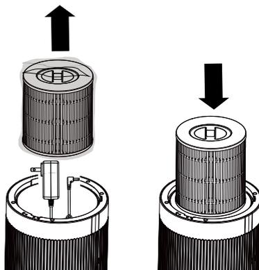
3. Réinstallez le couvercle du filtre. Assurez-vous d'aligner le triangle sur le couvercle du filtre avec le triangle sur le bord inférieur du purificateur d'air. Tournez le couvercle du filtre dans le sens des aiguilles d'une montre pour le verrouiller.
