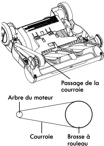
8. Réinstallez la brosse à rouleau dans le suceur de plancher en plaçant les embouts dans les fentes. Alignez en premier lieu l'embout du côté courroie de la brosse à rouleau sur la fente, puis insérez-le en place. Appuyez ensuite fermement sur l'embout du côté sans courroie dans la fente, ainsi qu'ilustré ci-dessous. Faites tourner la brosse à rouleau pour vous assurer que la courroie est correctement installée.
