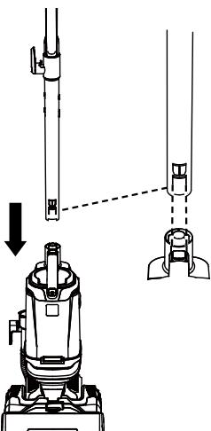
3. Alinee el pasador del soporte de accesorios con la parte frontal de la vara como se indica. Asegúrese de que el orificio ovalado se alinee con la parte correspondiente que sobresale de la vara. Empuje y haga calzar en la vara.
