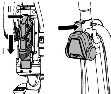
8. Asegúrese de que el gancho superior del cable esté en la posición correcta, tal como se indica. Envuelva el cable de alimentación sin apretar alrededor de los ganchos superior e inferior del cable.
