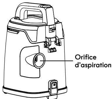
3. Placez la zone du bac à poussière de l'aspirateur au-dessus d'une poubelle. Appuyez sur le bouton de dégagement du bac à poussière pour ouvrir le couvercle du bac à poussière, puis renversez le contenu du bac dans la poubelle.
