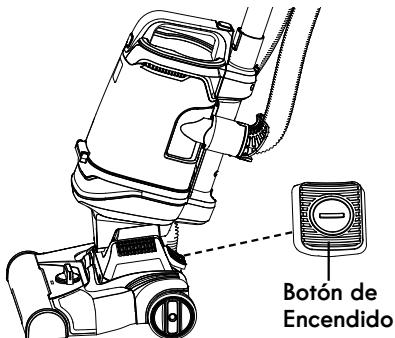
3. Cuando la aspiradora esté encendida, úsela inclinando la empuñadura hacia usted, dejando a la boquilla pareja con la superficie del suelo.
