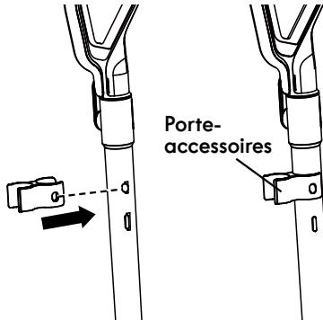
4. Alignez l'emplacement de rangement du tuyau sur le dos du tube, ainsi qu'ilustré. Assurez-vous que le grand trou ovale est aligné sur la protubérance correspondante sur le tube. Appuyez dessus afin qu'elle s'enclencher sur le tube.
