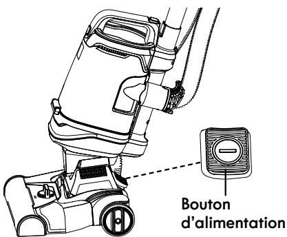
3. Une fois l'aspirateur en marche, faites-le fonctionner en inclinant le manche vers vous et en plaçant le suceur au niveau de la surface du plancher.
