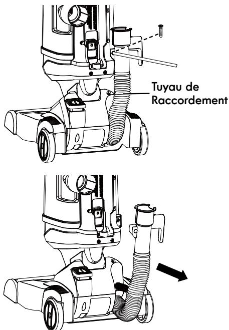
3. Réinstallez le tuyau de raccordement, puis fixez-le à l'aide de la vis. Ne pas serrer excessivement la vis.
