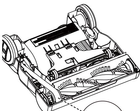
9. Réinstallez la plaque inférieure en alignant en premier lieu les languettes situées sur le bord avant de la plaque inférieure sur les fentes du suceur, puis appuyez sur la plaque inférieure en position installée.
