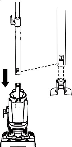
3. Alignez l'agrafe du porte-accessoires sur l'avant du tube, ainsi qu'ilustré. Assurez-vous que le trou ovale est aligné sur la protubérance correspondante sur le tube. Appuyez dessus afin qu'elle s'enclencher sur le tube.
