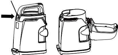
3. Nettoyez le pré-filtre en le tapotant en douceur au-dessus d'une poubelle. Tapotez sur plusieurs côtés afin de garantir un nettoyage optimal.
