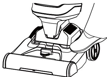
2. Mettez sous tension l'aspirateur en appuyant du pied sur le bouton d'alimentation.
