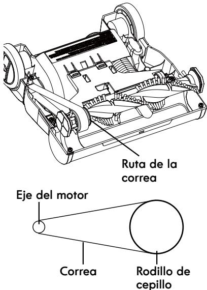
8. Reinstale el cepillo de rodillo en la boquilla para pisos colocando las tapas de los extremos en las ranuras. Primero, alinee la tapa del extremo del lado de la correa del cepillo de rodillo con la ranura e insértela en posición. Luego, presione la tapa del extremo del lado opuesto al de la correa con firmeza hacia la ranura como se indica a continuación. Gire el cepillo de rodillo para asegurarse de que la correa está instalada correctamente.
