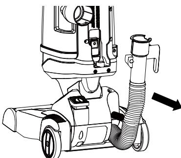
3. Reinstale la manguera de conexión y fíjela con el tornillo. No apriete el tornillo más de la cuenta.
