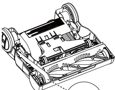
9. Reinstale la placa inferior alineando las lengüetas del borde frontal de la placa inferior con las ranuras de la boquilla primero; luego, presione la placa inferior hacia su posición de instalación.
