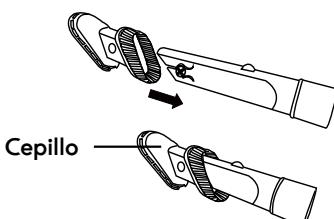
Para volver la herramienta combinada al modo de herramienta para grietas, presione el botón de liberación y deslice la herramienta de cepillo hacia abajo.
