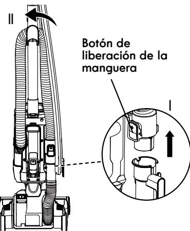
3. Elija el accesorio deseado/vara de extensión e insértelo en la manguera flexible.
