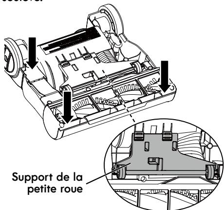
10. Réinstallez les six vis dans la plaque inférieure. Ne pas serrer les vis excessivement.
