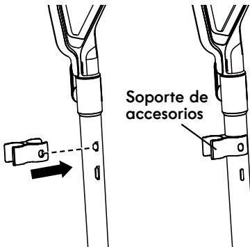
4. Alinee el colgador de la manguera con la parte posterior de la vara como se indica. Asegúrese de que el orificio ovalado grande se alinee con la parte correspondiente que sobresale de la vara. Empuje y haga calzar en la vara.
