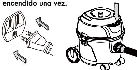
10. Tras haber terminado de aspirar, presione nuevamente el botón de encendido para apagar el motor y desconecte el cable de alimentación de la toma de corriente.
