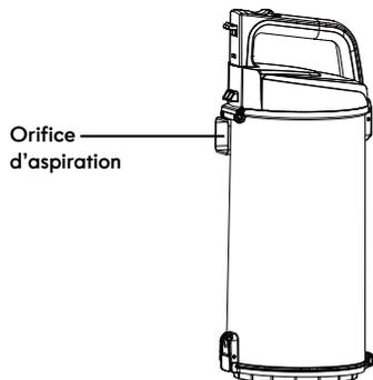
3. Placez la zone du bac à poussière de l'aspirateur au-dessus d'une poubelle. Appuyez sur le bouton de déverrouillage du bac à poussière pour ouvrir le couvercle du bac à poussière, puis renversez le contenu du bac dans la poubelle.
