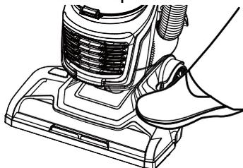
2. Encienda la aspiradora colocando el interruptor de encendido/apagado en la posición "I" para limpiar pisos lisos y pequeños cubrepisos.
