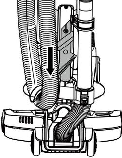
5. Asegúrese de que los ganchos superior e inferior del cable estén en la posición correcta como se indica. Envuelva el cable de alimentación sin apretar alrededor de los ganchos del cable superior e inferior.
