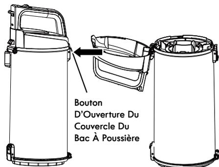
3. Saisissez le pré-filtre, puis faites-le tourner dans le sens inverse des aiguilles d'une montre ainsi qu'illustré pour le retirer.
