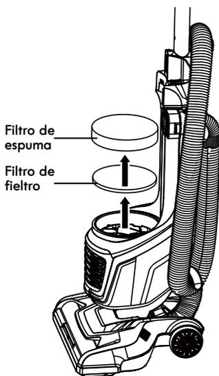
3. Lave usando solo agua fría, NO use detergentes o jabón. Estruje a mano y deje secar al aire. Deje secar todos los filtros durante 24 horas antes de volver a colocarlos en la aspiradora.
