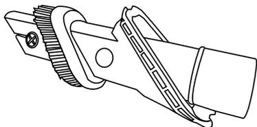
Mettez l'outil à usages multiples en mode Brosse à épousseter en appuyant sur le bouton de dégagement et en faisant coulisser le côté brosse à épousseter de la brosse jusqu'à l'extrémité de l'outil à usages multiples. Utilisez le mode Brosse à épousseter pour nettoyer les surfaces instables, notamment les rideaux. Voir le **TABLEAU D'UTILISATION DES ACCESSOIRES** (page 12).
