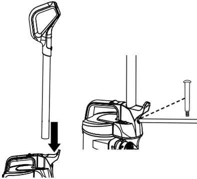
2. Inserte el extremo más grande de la vara de extensión en la parte superior de la manguera de conexión mediante la abrazadera hasta que la vara quede totalmente asentada en el poste.
