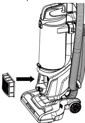
5. Insérez les languettes du couvercle du logement du filtre d'évacuation dans les fentes supérieures, puis verrouillez en place le couvercle en appuyant sur la partie inférieure du couvercle jusqu'à ce qu'un déclic se fasse entendre.
