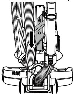
5. Assurez-vous que les crochets d'enroulement supérieur et inférieur du cordon sont correctement positionnés, ainsi qu'illustré. Enroulez le cordon d'alimentation sans le serrer autour des crochets d'enroulement supérieur et inférieur du cordon.
