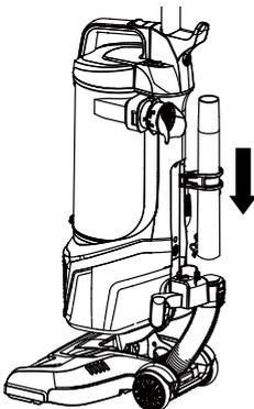
3. Inserte el extremo de la manguera flexible en la unidad principal alineando las marcas de DESBLOQUEADO (para limpiar). Gire la manguera hasta que las marcas BLOQUEADO (para usar) se alineen. Luego, pase la manguera flexible sobre el almacenamiento de la manguera inferior y superior. Inserte el otro extremo en la parte superior de la vara de extensión.
