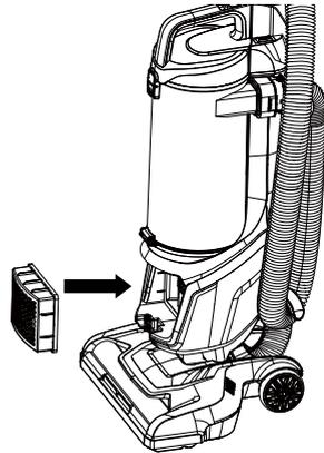
5. Inserte las pestañas de la cubierta del filtro de escape en las pestañas superiores y fije la cubierta en posición presionando la parte inferior de ella hasta escuchar un clic.
