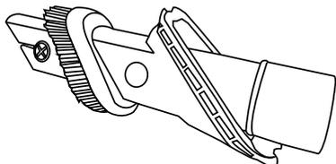
Configure la herramienta combinada en modo cepillo para limpiar polvo presionando el botón de liberación y deslizando el costado con cepillo de la herramienta hacia el extremo de la herramienta combinada. Use en modo cepillo para limpiar polvo para limpiar superficies holgadas, como cortinas. Consulte la TABLA DE USO DE ACCESORIOS (página 12).
