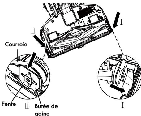
8. Réinstallez la plaque inférieure en alignant sur les fentes de la buse les languettes situées sur le bord avant de la plaque inférieure, en insérant les languettes en place, puis en tournant la plaque inférieure en position installée.
