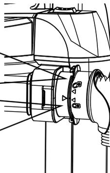
3. Retire el extremo de la manguera , Revise y saque cualquier tapón de la manguera flexible.
