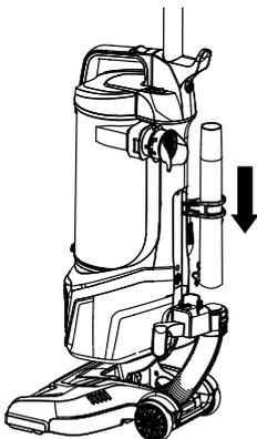
3. Insérez l'extrémité du tuyau flexible dans le corps principal en alignant les indications ainsi qu'illustré dans la section UNLOCKED (Déverrouillé) (pour nettoyage). Tournez le tuyau jusqu'à ce que les indications s'alignent ainsi qu'illustré dans la section LOCKED (Verrouillé) (utilisation). Faites ensuite passer le tuyau flexible par dessus l'emplacement de rangement inférieur et l'emplacement de rangement supérieur. Insérez l'autre extrémité sur la partie supérieure du tube de rallonge.
