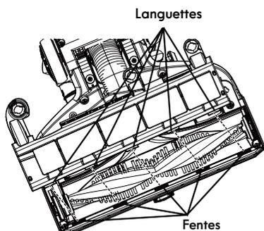
9. Appuyez sur la plaque inférieure sur la buse jusqu'à ce qu'un déclic se fasse entendre, puis fixez-la en tournant les loquets de la plaque inférieure dans le sens des aiguilles d'une montre jusqu'à les positionner sur LOCK (Verrouillage).
