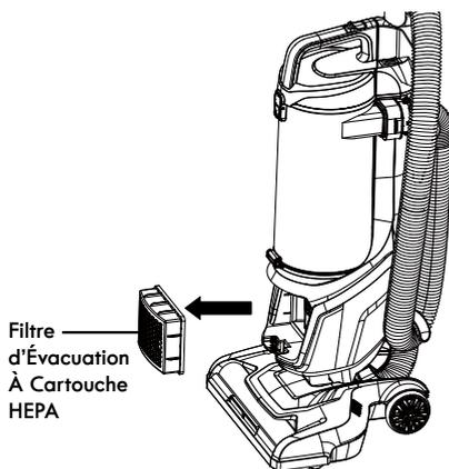
3. Lavez-le à l'eau froide uniquement. NE PAS utiliser de détergents ou du savon. Laissez-le sécher à l'air libre. Laissez les pièces sécher 24 heures avant de les remettre dans l'aspirateur.
