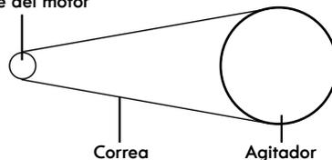
7. Reinstale el agitador en la boquilla colocando las tapas del extremo en las ranuras. Primero, alinee la tapa del extremo del costado del agitador que no tiene la correa con la ranura e inserte en posición. Luego, presione la tapa del extremo que tiene la correa con firmeza hacia la ranura hasta escuchar un clic. Revise el agitador para asegurarse de que gira sin problemas.
