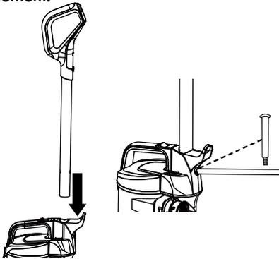
2. Insérez l'extrémité la plus large du tube de rallonge dans la partie supérieure du tuyau de raccordement à travers le support jusqu'à ce que le tube repose complètement contre le poteau.
