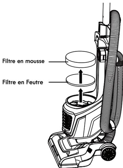
3. Lavez-le à l'eau froide uniquement. NE PAS utiliser de détergents ou du savon. Pressez-le à la main, puis laissez-le sécher à l'air libre. Laissez les filtres sécher 24 heures avant de les remettre dans l'aspirateur.
