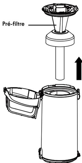
4. Nettoyez le pré-filtre en le tapotant délicatement au-dessus d'une poubelle. Tapotez sur plusieurs côtés afin de garantir un nettoyage optimal.
