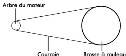
7. Réinstallez la brosse à rouleau dans la buse en plaçant les embouts dans les fentes. Alignez en premier lieu l'embout sur la fente située du côté de la brosse à rouleau où ne se trouve pas la courroie, puis insérez-le en place. Ensuite, appuyez fermement sur l'embout pour l'insérer dans la fente située du côté de la brosse à rouleau où se trouve la courroie jusqu'à ce qu'un déclic se fasse entendre. Assurez-vous que la brosse à rouleau tourne librement.
