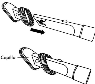
Para devolver la herramienta combinada a modo hendiduras, presione el botón de liberación y deslice el cepillo por la herramienta combinada.
