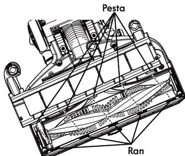
9. Presione la placa inferior hacia la boquilla hasta escuchar un clic y asegúrela girando los seguros hacia la derecha hacia la posición de bloqueo.
